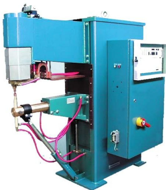
рис. PMS 16-4 в исполнении А точечная сварка
